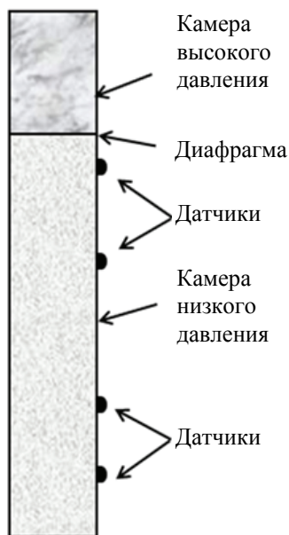
Рис. 1. Схема ударной трубы для исследования пузырьковых жидкостей
